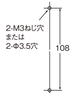
取り付け穴加工寸法
