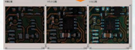
SMT工程で発生する不良はプロセス要因でなく、設計起因によるものが重大です。不良事象と関連する設計情報(CADデータ)を重ね合わせて分析することにより、この設計起因の不良要因を分析し、設計段階から不良の発生を未然防止することができます。(分析履歴は別売のQ-upCasesに蓄積、活用することができます。)
