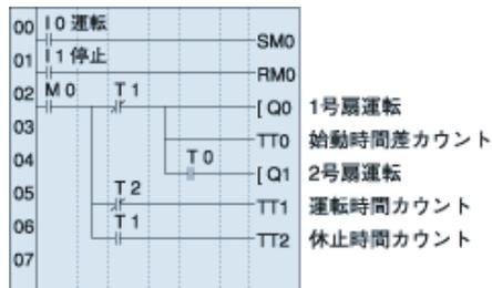
運転スイッチを押すと攪拌扇1号が始動し、30秒後に攪拌扇2号が始動。1時間運転、1時間30分停止の動作を繰り返します。
