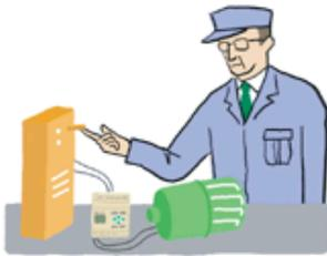
耐久試験などで、試験対象のON/OFF動作を行います。運転スイッチを押すと設定した時間でON/OFFを繰り返す、設定した回数になると自動的に停止します。
