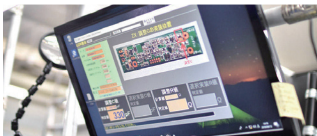
作業者はモニタに表示されるデジタル作業指示により、実装位置や調整値を確認し、正しい部品を実装。
