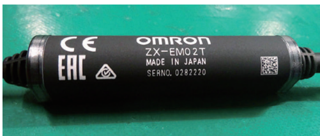
2次元コードを印刷した銘板が巻かれた高精度センサ
