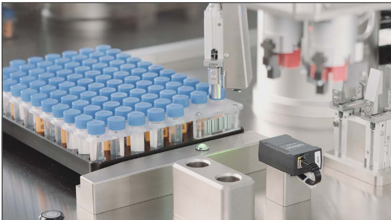
プレートの情報をバーコードから読取り、ミスを防いで作業を高速化
