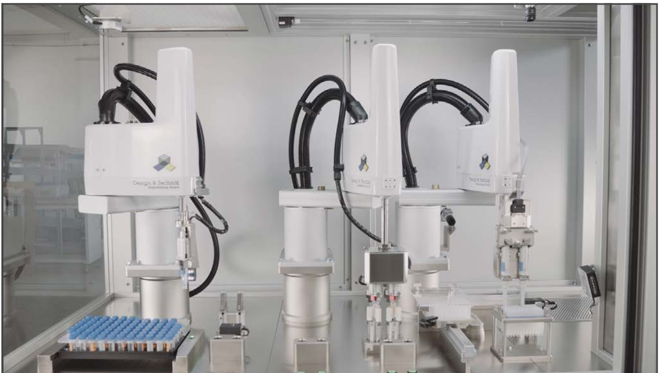
オムロンのスカラロボットCobra 450を使った非接触ラボシステムPT600
