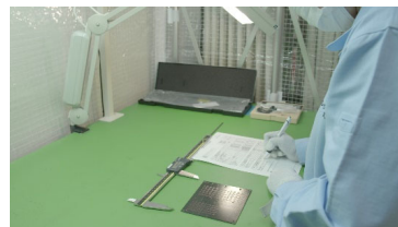
部材の受け入れ場の一角にて、「抜き取り」にて作業員が検査を実施。検査対象は、寸法検査、目視など多岐に渡る。
