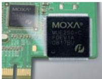
Moxaは設立当初から自社開発を続けているシリアルインターフェース製品に対して、専用のUART (Universal Asynchronous Receiver/Transmitter) チップを採用しています。高性能UARTチップにより、マルチポート環境にて高速ボーレート通信を提供することができます。またPCI Express用には、ブリッジチップとUARTチップをひとつのチップに統合しました。これによりスループットを33%向上させるとともに、CPUの負荷を48%低下させます。独自開発のチップを採用し優れたパフォーマンスを提供することで、他社との差別化を図るとともに、長期的な安定供給を約束することが可能です。
