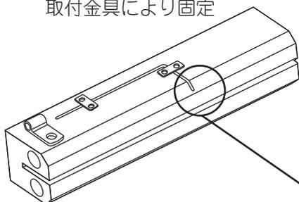
例 2) 熱板に温度センサの溝を作り、
