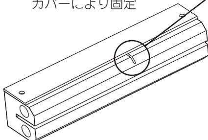
例 3) 熱板に温度センサの横穴を作り、挿入
