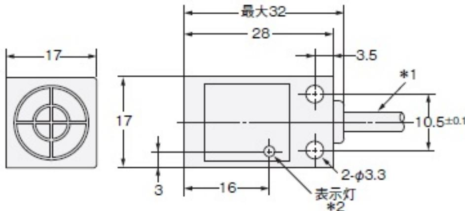
\*1. Cタイプ：ビニル絶縁丸形コードφ4、3芯(導体断面積：0.2mm<sup>2</sup>、絶縁体径：φ1.2mm)標準2m
