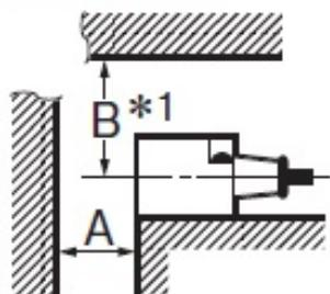
\*1. B寸法は上面、左右の側面に対しても適用されます。
