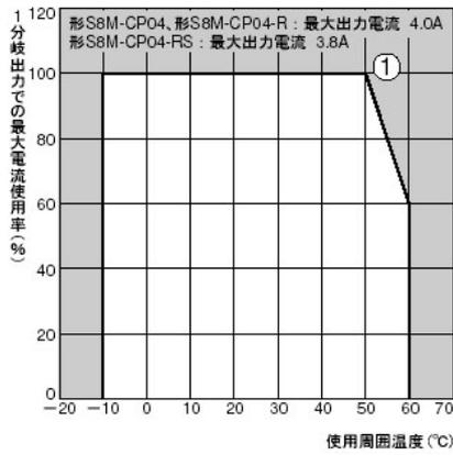
形S8Mのデレーティング曲線とは通常状態で流れる1分岐出力の最大電流値によって制限される使用可能な周囲温度です。
