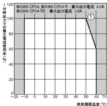
形S8Mのディレーティング曲線とは通常状態で流れる1分岐出力の最大電流値によって制限される使用可能な周囲温度です。
