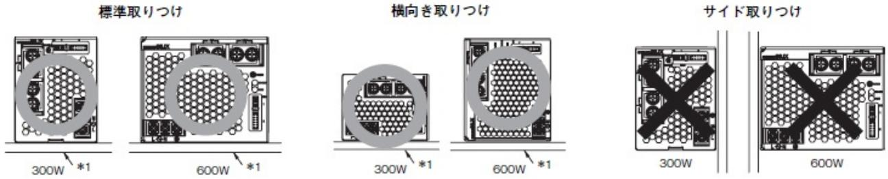
注1. 取り付け状態により放熱性が悪化し、稀に内部部品が劣化・破損する恐れがあります。標準取り付け以外で使用しないでください。
