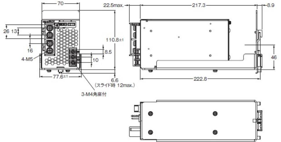
注. 300WタイプをDINレール取り付けする場合は、鉄製DINレールをお使いください。
