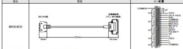
※BCD出力専用ケーブルにはDモード接続用のプラグが付属しています。
