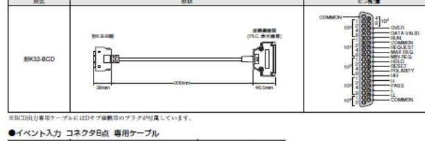
※BCD出力専用ケーブルにはDモード接続用のプラグが付属しています。
