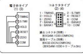
※BCD出力専用ケーブルにはDモード接続用のプラグが付属しています。
