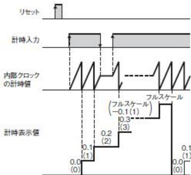
\* 計時中はLCD(液晶)の小数点が1秒おきに点滅します。
