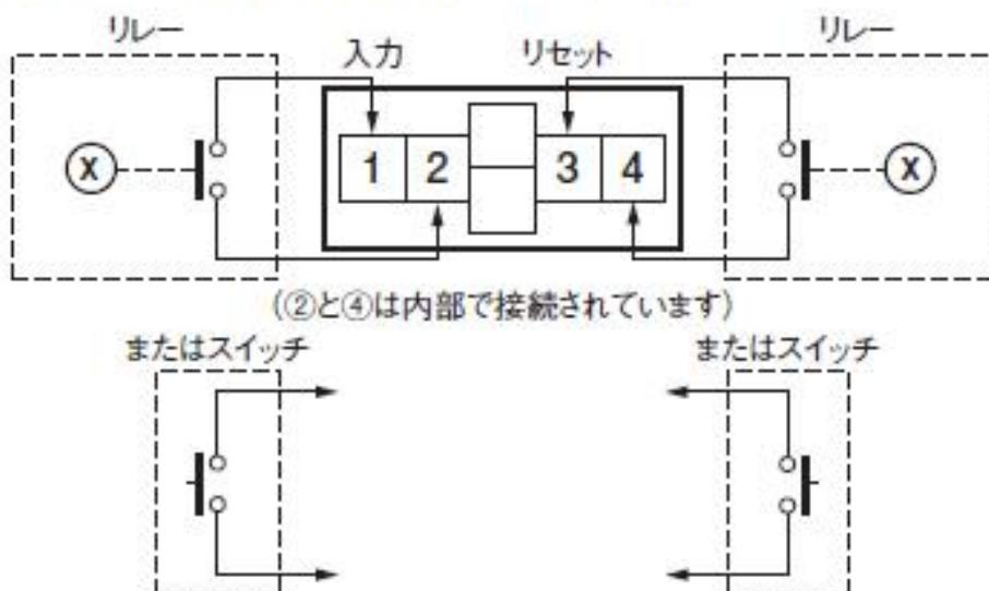
注. ①、③端子から流出する電流が小さいため、接触信頼性のよいリレーやスイッチをご使用ください。
