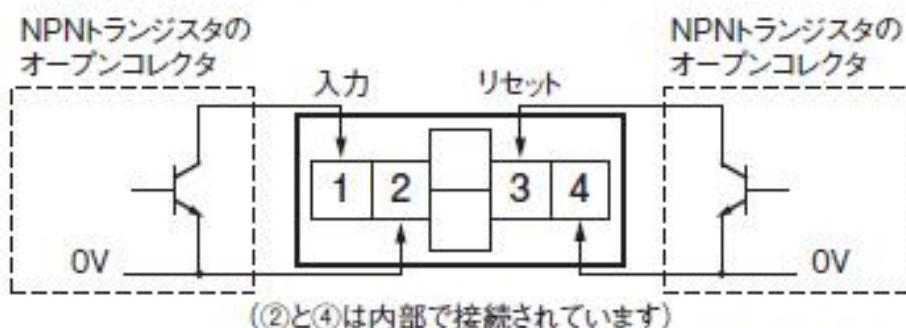
注1. ①、③番端子から流出する電流が小さいため近接スイッチ、光電スイッチなどの出力部の残留電圧は小さくなります(0.5V未満)ので容易に接続可能です。
