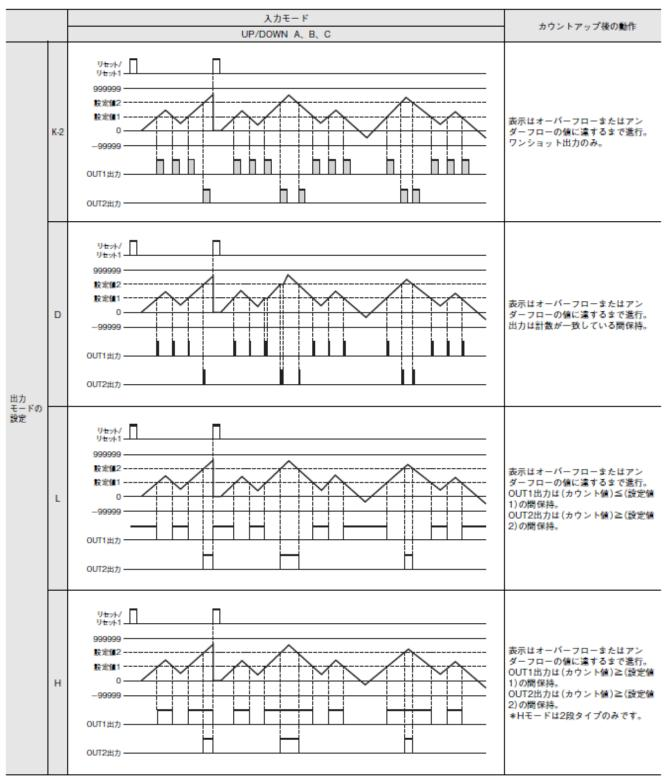
注1. リセット/リセット1入力中は計数を受け付けません。 注2. ワンショット出力がONの時、リセット/リセット1が入力されるとワンショット出力はその場でOFFします。 注3. 出力ON中に電断が発生し、停電記憶が有効な場合、電断復帰後、出力がONします。 出力がワンショット出力の場合は、電断復帰後、再度出力設定分の出力が出ます。 注4. ワンショット出力中に再度カウントアップされる使い方はしないでください。 注5. 設定値は一99999~999999です。
