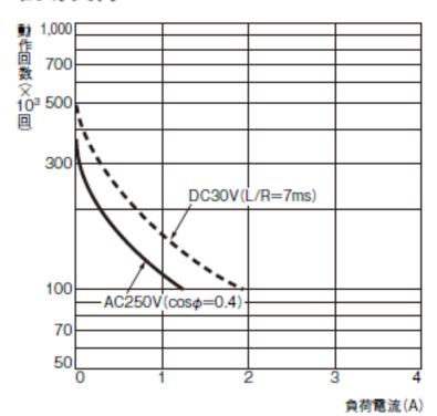
DC125V cos φ = 1で0.15A max.開閉可(寿命10万回) L/R=7msで0.1A max.開閉可(寿命10万回)
