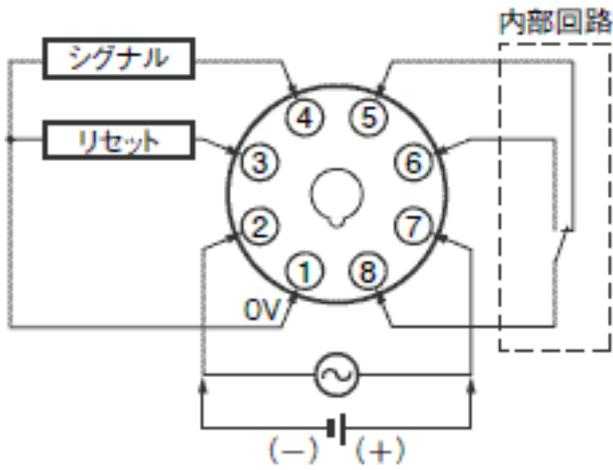
形H5CX-L8D-Nの①-②端子は内部で接続されています。
