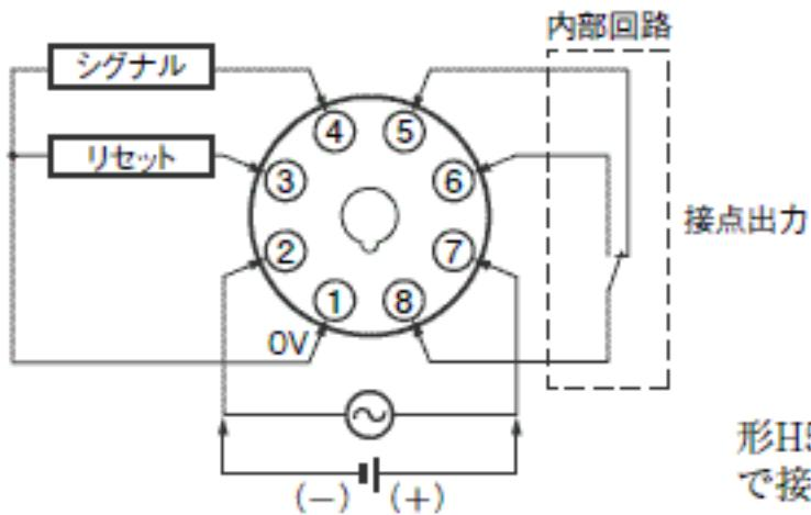
形H5CX-L8D-Nの①-②端子は内部で接続されています。
