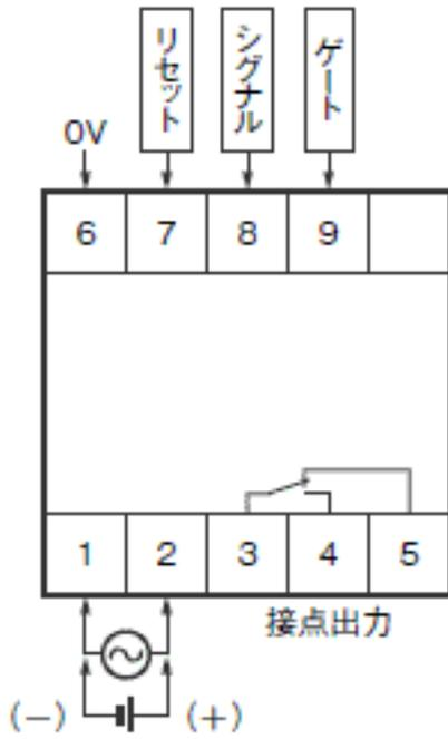
形H5CX-AD-Nの①-⑥端子は内部で接続されています。
