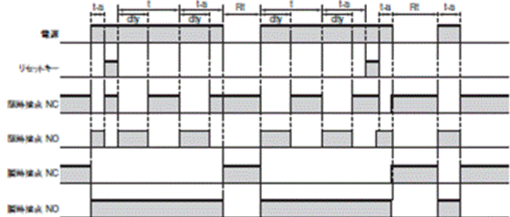
t=セット時間, dy=ONデューティ時間, Rt=復帰時間(0.5秒以上), t-on< (セット時間未満を示す)
