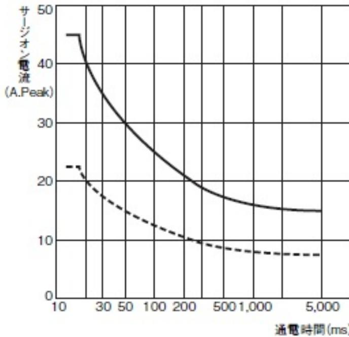
繰り返しの場合、破線の突入電流耐量以下としてください
