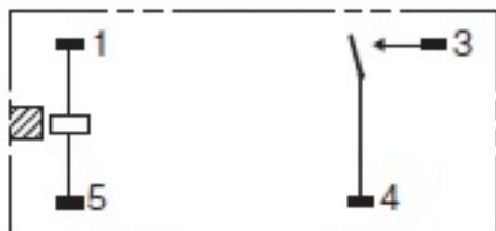
端子配置/内部接続図 (BOTTOM VIEW)
