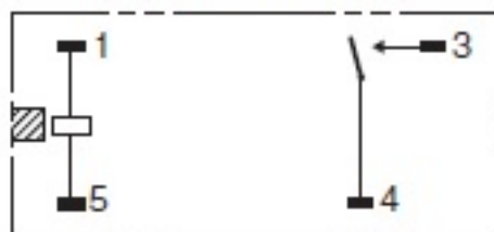
端子配置/内部接続図 (BOTTOM VIEW)
