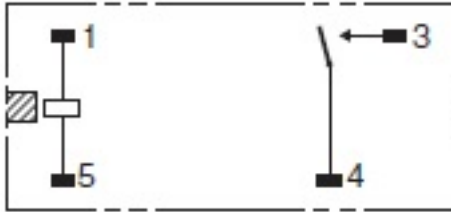
端子配置/内部接続図 (BOTTOM VIEW)
