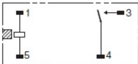
端子配置/内部接続図 (BOTTOM VIEW)
