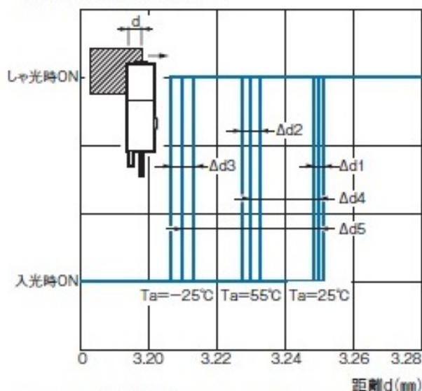
Vcc=12V 繰り返し数：20  $\Delta d1=0.002\text{mm}$   $\Delta d2=0.004\text{mm}$
