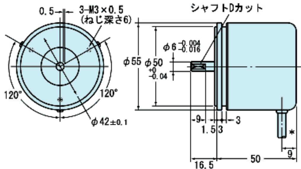
\* ビニル絶縁丸形シールドコード 外径Φ5.5/Φ0.18、5芯 標準500mm
