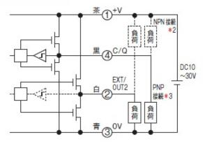
IO-Linkモード (Pin2出力 設定時)
