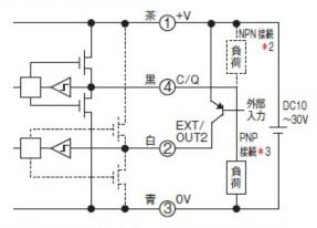
Pin2を制御出力として使用する場合 (IO-Linkで設定)
