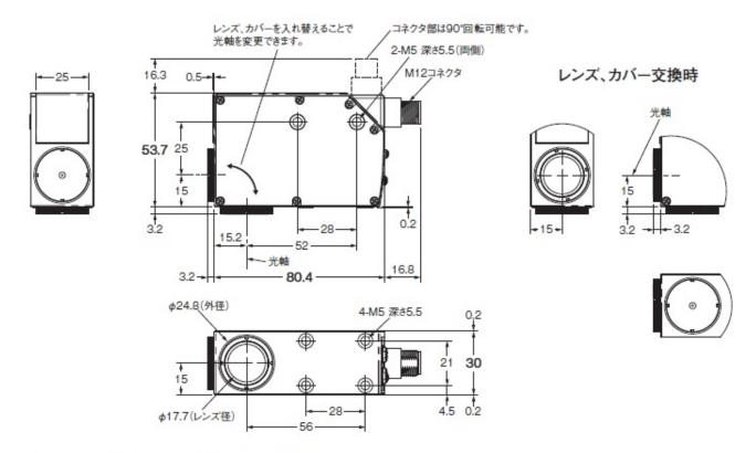
注1. ネジの取付けトルクは2.0N.m以下でご使用ください。 2. 外付けレンズ、カバーは筐体に密着するまで締め付けてください。
