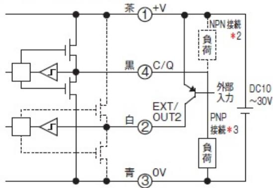
Pin2を制御出力として使用する場合
