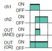
2. 制御出力(AND/OR)タイムチャート(T：設定時間)
