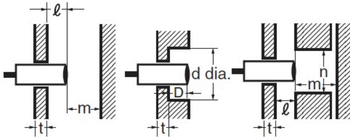
l: 0 mm min., dia. d: 18 mm min., D: 0 mm min., m: 24 mm min., n: 27 mm min.
