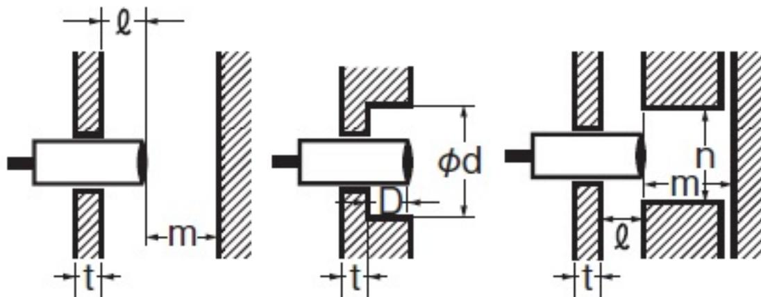
$l$ : 0mm以上、 $\phi d$ : 18mm以上、 $D$ : 0mm以上、 $m$ : 24mm以上、 $n$ : 27mm以上
