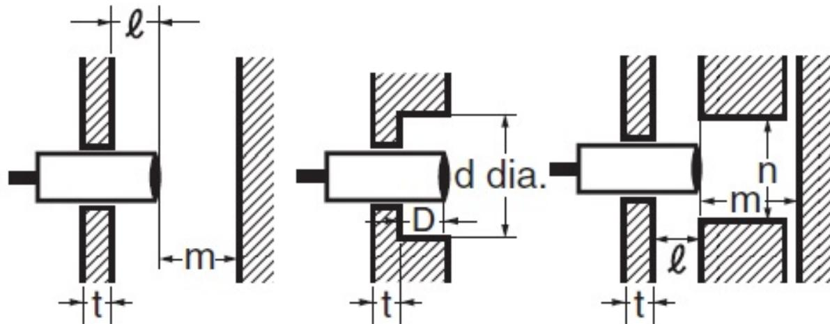
l: 0 mm min., dia. d: 12 mm min., D: 0 mm min., m: 12 mm min., n: 18 mm min.
