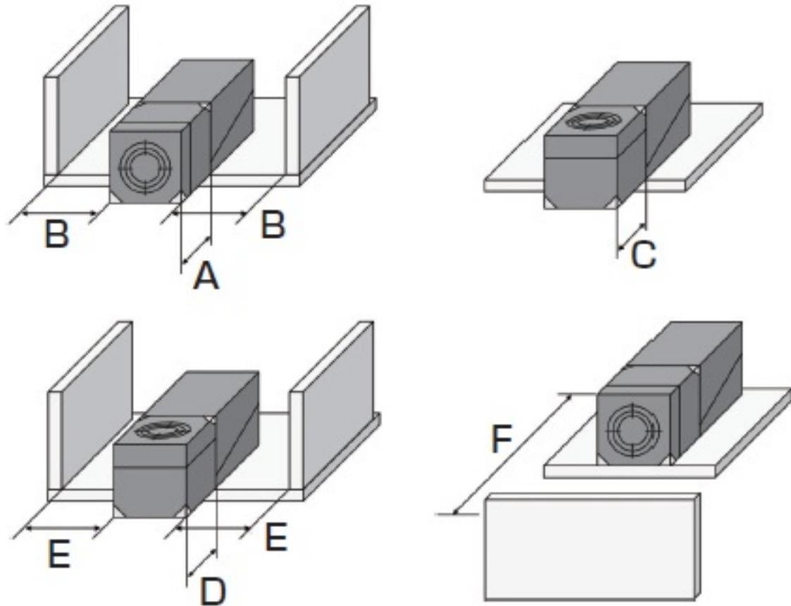
A: 0 mm min., B: 0 mm min., C: 0 mm min., D: 0 mm min., E: 10 mm min., F: 60 mm min.
