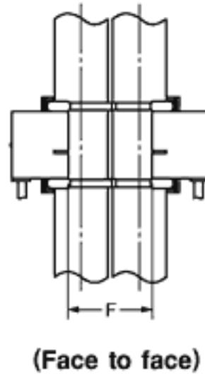
D: 10 mm min., E: 10 mm min., F: 30 mm min.
