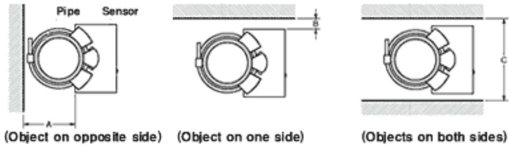
A: 25 mm min., B: 0 mm min., C: 40 mm min.
