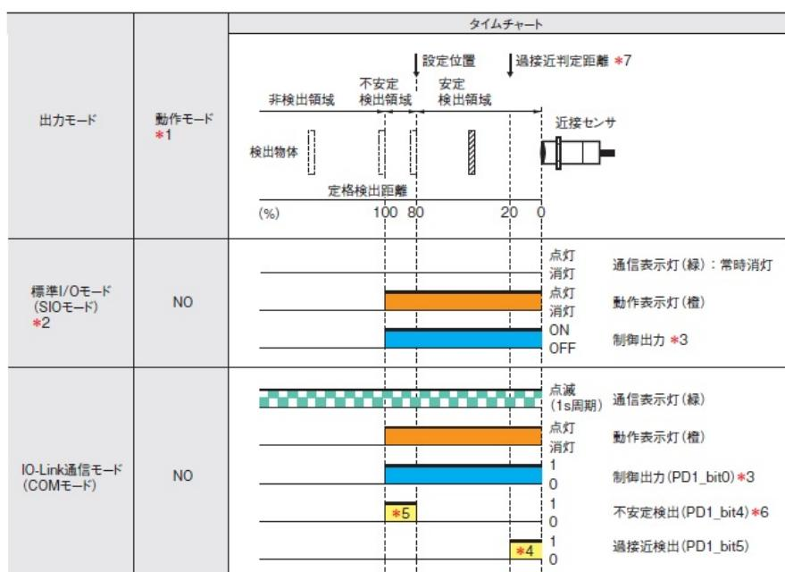
\*3. IO-Link通信により、制御出力のタイマ機能の設定が可能です。(ONディレイ、OFFディレイ、ワンショット、ONOFFディレイの機能選択および1~16,383msのタイマ時間Tの設定が可能。)
