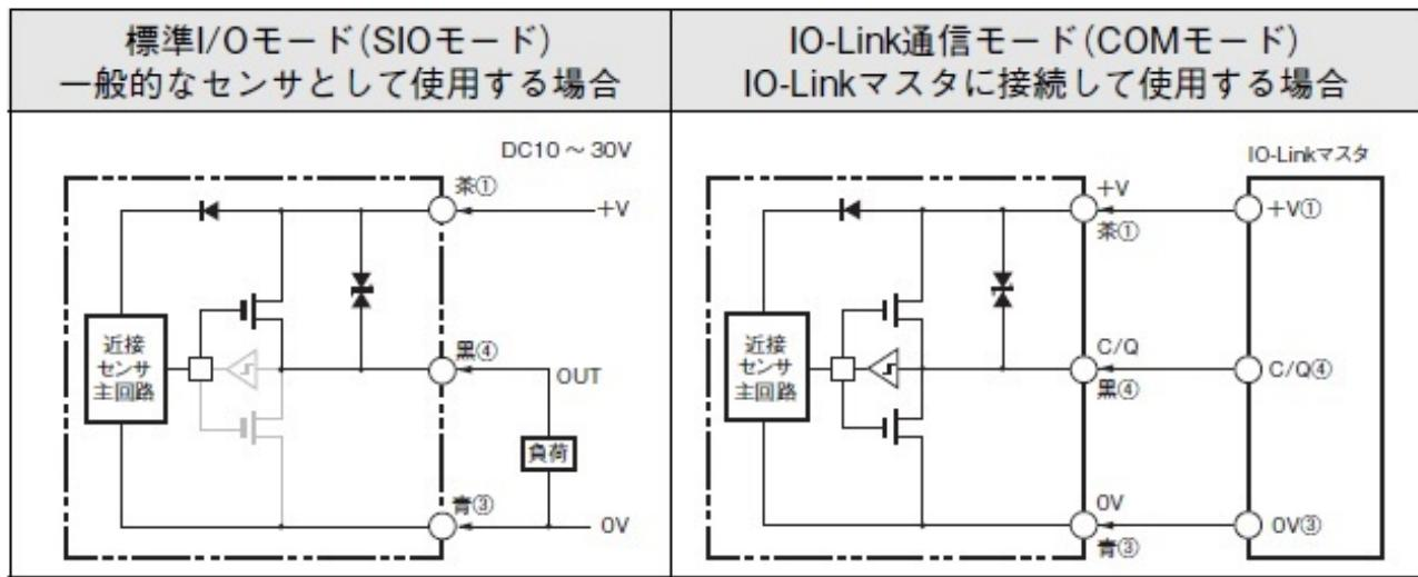
IO-LinkモードではIO-Linkマスタとセンサ間のコード長は20m以下としてください。
