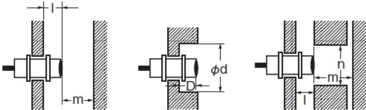
$l$ : 0mm以上、 $\phi d$ : 18mm以上、 $D$ : 0mm以上、 $m$ : 20mm以上、 $n$ : 27mm以上
