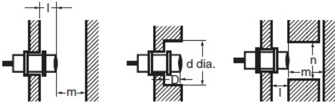
$l$ : 0 mm min., dia.  $d$ : 18 mm min.,  $D$ : 0 mm min.,  $m$ : 20 mm min.,  $n$ : 27 mm min.
