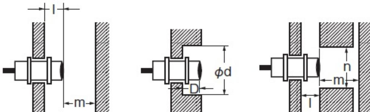
$l$ : 0mm以上、 $\phi d$ : 12mm以上、 $D$ : 0mm以上、 $m$ : 8mm以上、 $n$ : 18mm以上
