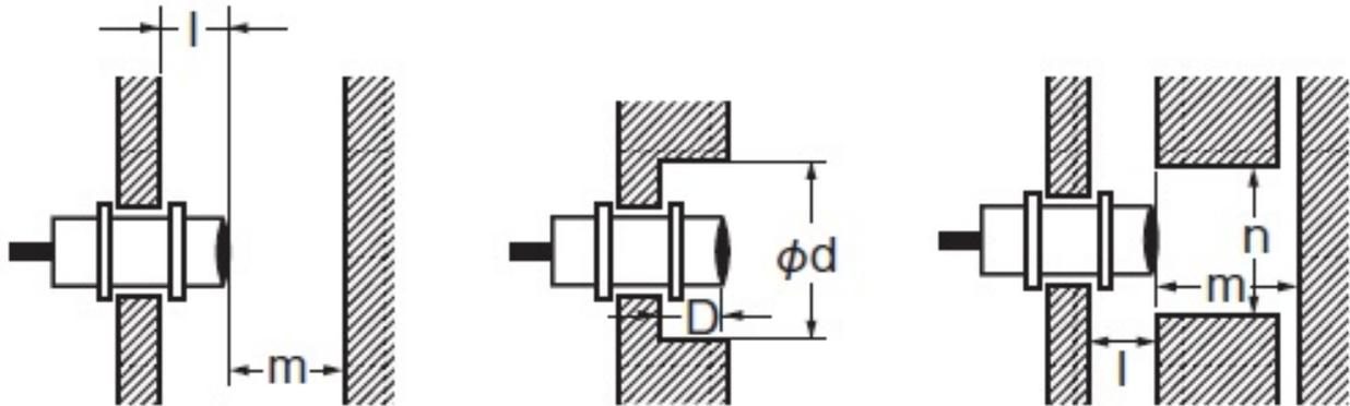
$l$ : 6mm以上、 $\phi d$ : 50mm以上、 $D$ : 6mm以上、 $m$ : 45mm以上、 $n$ : 50mm以上
