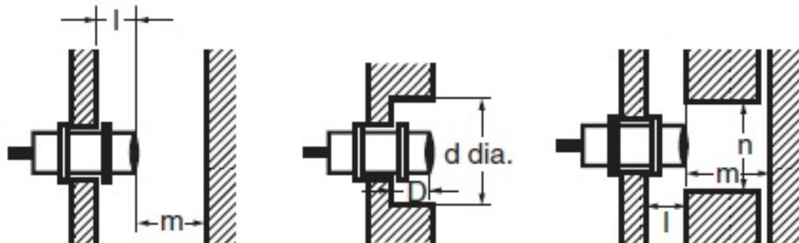
l: 6 mm min., dia. d: 50 mm min., D: 6 mm min., m: 45 mm min., n: 50 mm min.
