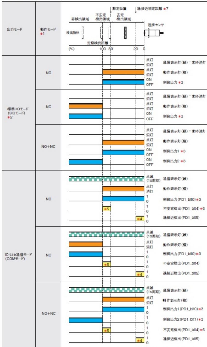
\*3. IO-Link通信により、制御出力のタイマ機能の設定が可能です。(ONディレイ、OFFディレイ、ワンショットの機能選択および1~16383msのタイマ時間の設定が可能です。)
