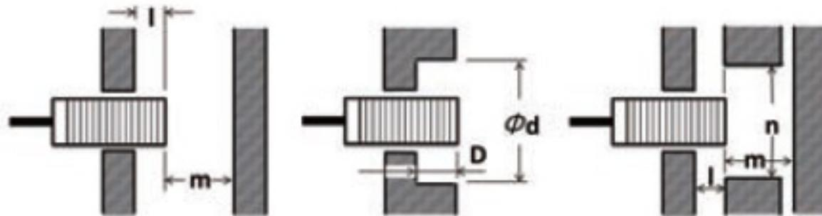
l: 30mm以上、 $\phi d$ : 90mm以上、D: 30mm以上、m: 70mm以上、n: 90mm以上
