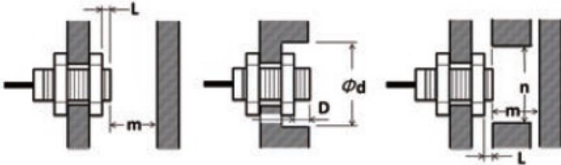
L: 25mm以上、 $\phi d$ : 90mm以上、D: 25mm以上、m: 70mm以上、n: 90mm以上
