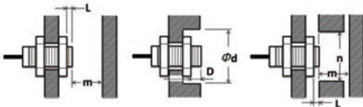
L: 21mm以上、 $\phi d$ : 70mm以上、D: 21mm以上、m: 48mm以上、n: 80mm以上
