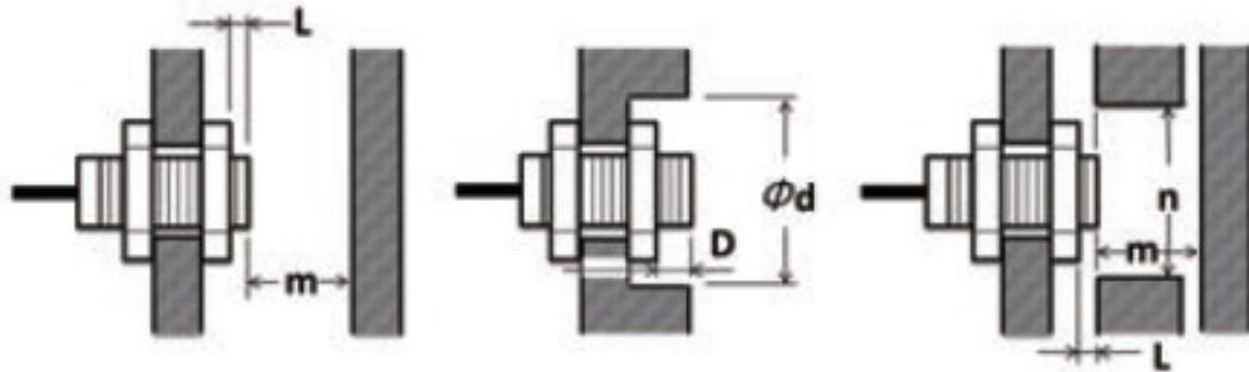
L: 18 mm min., dia. d: 55 mm min., D: 18 mm min., m: 40 mm min., n: 54 mm min.
