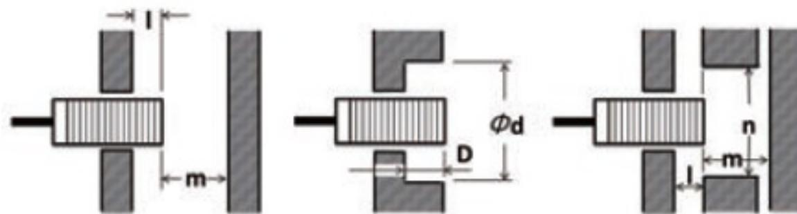
l: 22 mm min., dia. d: 55 mm min., D: 22 mm min., m: 40 mm min., n: 54 mm min.
