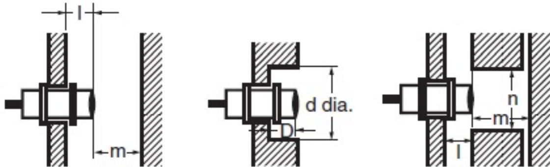
l: 22 mm min., dia. d: 70 mm min., D: 22 mm min., m: 40 mm min., n: 70 mm min.
