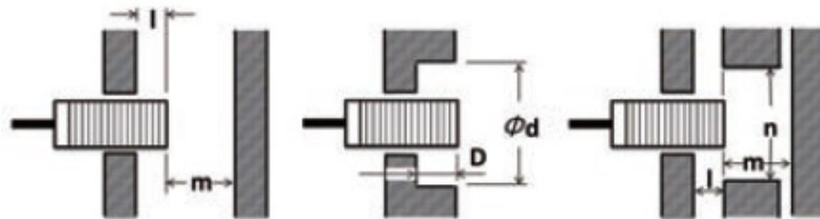
l: 0mm以上、 $\phi d$ : 30mm以上、D: 0mm以上、m: 40mm以上、n: 45mm以上
