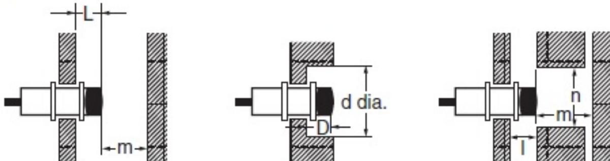
L: 0 mm min., dia. d: 6.5 mm min., m: 6 mm min., D: 0 mm min., n: 12 mm min., c: 2 mm min.
