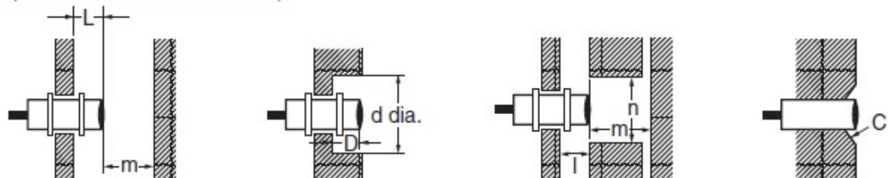
L: 6 mm min., dia. d: 9 mm min., m: 6 mm min., D: 6 mm min., n: 16 mm min.
